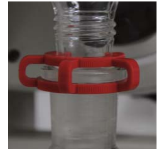
[6] Incluye clip para sujeción del matraz de recepción al refrigerante
