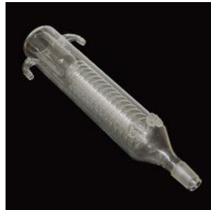
[3] Refrigerante en serpentín con elevada superficie de condensación
